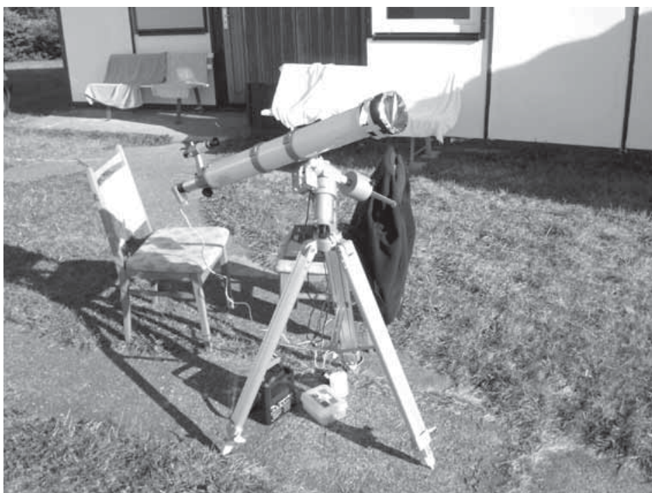
Die Ausrüstung (Vixenrefraktor 90/1000 plus Baader-Fienfilter, Webcam PhilipsToUCamPro II (740k)) vor dem Hauptgebäude der Kirchheimer Sternwarte.
